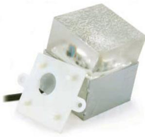
Corpo illuminante in resina, carrabile e calpestabile. Apparecchio ideale per luce di segnalazione su pavimenti in pietra o simili. Fornito con LED 1W, controcassa e cavo H05RN-F 2x1 (mm<sup>2</sup>) L= 2,80mt. Alimentazione 12/ 7.5V, gestione colore RGB e/o dimmer.
