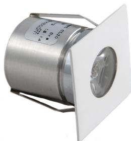
Corpo illuminante da incasso, con frontale quadrato bianco, per illuminazione da interni. Fornito con un LED da 1.5W, ottiche 20° e 55°. Nella versione RGB è fornito con LED 3x1.5W, ottica 25° e 40°. Alimentazione 12/24V, collegamento in parallelo, gestione colore e/o dimmer.
