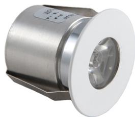
Corpo illuminante da incasso, con frontale tondo bianco, per illuminazione da interni. Fornito con un LED da 1.5W, ottiche 20° e 55°. Nella versione RGB è fornito con LED 3x1.5W, ottica 25° e 40°. Alimentazione 12/24V, collegamento in parallelo, gestione colore e/o dimmer.
