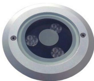
Apparecchio ad incasso in alluminio anticorrosivo, satinato brillante. Per esterni, giardini o terrazze. Fornito con 9 LED da 1W, ottiche 15°, 25°, 40° e cavo H05RN-F 2x1,5 (mm<sup>2</sup>) L=2,80mt. Nella versione RGB con cavo di alimentazione standard 14mt. Alimentazione 12V, gestione colore RGB e/o dimmer.
