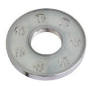
Corpo illuminante in acciaio INOX AISI 316, finitura lucida, per applicazione in fontane (filetto da 2"). Profondità di immersione max 2mt. Fornito con 21 LED da 1W, ottiche 15°, 25°e 40° e cavo H05RN-F 2x1,5 mm2 L=2,8mt. Alimentazione 24V, gestione colore RGB e/o dimmer.
