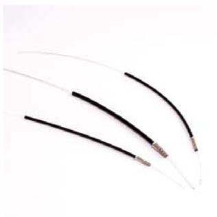
Monofibra sintetica in PMMA, senza rivestimento, ad emissione finale. Grazie ai minimi spessori, questo prodotto si presenta molto flessibile e quindi idoneo per la realizzazione di cieli stellati, illuminazione di decoro in cartongesso, pareti, mattonelle, pavimenti, piscine. Il rivetto terminale agevola il fissaggio nel cartongesso senza ricorrere all'ausilio di collanti od altro.
