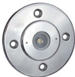
Corpo illuminante in acciaio INOX AISI 316, finitura lucida. Apparecchio ad incasso esclusivamente per immersione in piscine e piscine con teloni. Fornito con 3 LED da 2W, ottiche 15°, 25°, 40° e cavo H05RN-F 2x1 (mm<sup>2</sup>) L=50cm. Alimentazione 12/7.5 V, gestione colore RGB e/o dimmer.
