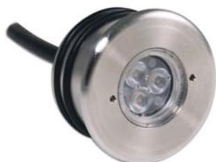
Corpo illuminante in acciaio INOX AISI 316, satinato . Apparecchio ad incasso maggiormente indicato per esterni o immersione (max 2mt). Fornito con 3 LED da 2W, ottiche 15°, 25°,40° e cavo H05RN-F 2x1 (mm2) L=50cm. Alimentazione 12/24V, gestione colore RGB e/o dimmer.
