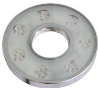
Corpo illuminante in acciaio INOX AISI 316, finitura lucida, per applicazione in fontane (filetto da 2"). Profondità di immersione max 2mt. Fornito con 21 LED da 1W, ottiche 15°, 25° e 40° e cavo H05RN-F 2x1,5 mm2 L=2,8mt. Alimentazione 24V, gestione colore RGB e/o dimmer.
