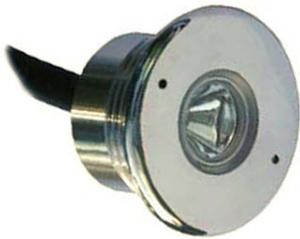
Corpo illuminante in acciaio INOX AISI 316, finitura lucida. Apparecchio ad incasso, con filettatura 1/4", maggiormente indicato per esterno ed immersione. Versione LED 1.5W / 6W, ottiche 15°, 25°, 40° e cavo H05RN-F 2x1 (mm<sup>2</sup>) L=50cm. Alimentazione 12/7.5V, gestione colore RGB e/o dimmer.
