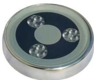
Corpo illuminante in acciaio INOX AISI 316, finitura lucida. Versione Pool esclusivamente per piscine e fontane. Fornito con 9-18 LED da 1W, ottiche 15°, 25°, 40° e cavo H05RN-F 2X1 (mm<sup>2</sup>) L=2,80 m. Nella versione RGB con cavo di alimentazione standard 14mt. Alimentazione 12/24V, gestione colore RGB e/o dimmer.
