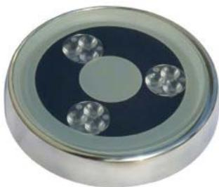
Corpo illuminante in acciaio INOX AISI 316, finitura lucida. Outdoor o immersione. Fornito con 9 LED da 1W, ottiche 15°, 25°, 40° e cavo H05RN-F 2X1 (mm2) L=2,80 m. Nella versione RGB con cavo di alimentazione standard 14mt. Alimentazione 12V, gestione colore RGB e/o dimmer.
