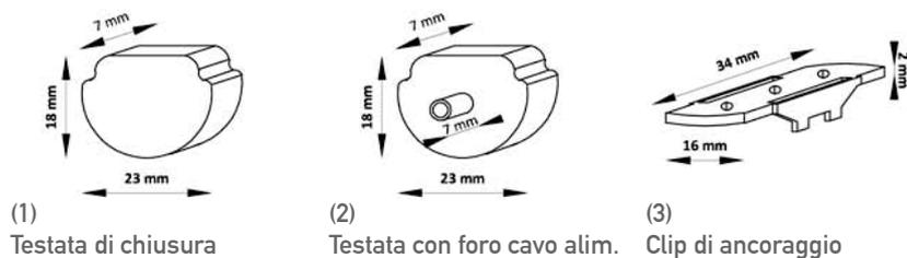
(1) Testata di chiusura (2) Testata con foro cavo alim. (3) Clip di ancoraggio
