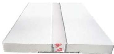
CLA: Canale Luminoso Assemblato. Estruso di alluminio bianco opaco abbinato con due sezioni di cartongesso alta densità, biadesivo 3M dissipante, per un doppio fissaggio, e diffusore opaco con pellicola di protezione. Prodotto dedicato per strutture in cartongesso, ideale per sviluppare giochi di linee luminose su parete-soffitto e/o parete-parete.
