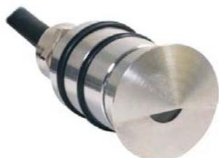
Segnapasso ad incasso in acciaio INOX AISI 316 satinato. Ghiera frontale con visiera per taglio di luce angolare 160° e vetrino opaco, per interni ed esterni. Fornito con LED da 2W, cavo standard H05RNF L=50cm. Alimentazione 24V, collegamento in parallelo, dimmerabile.
